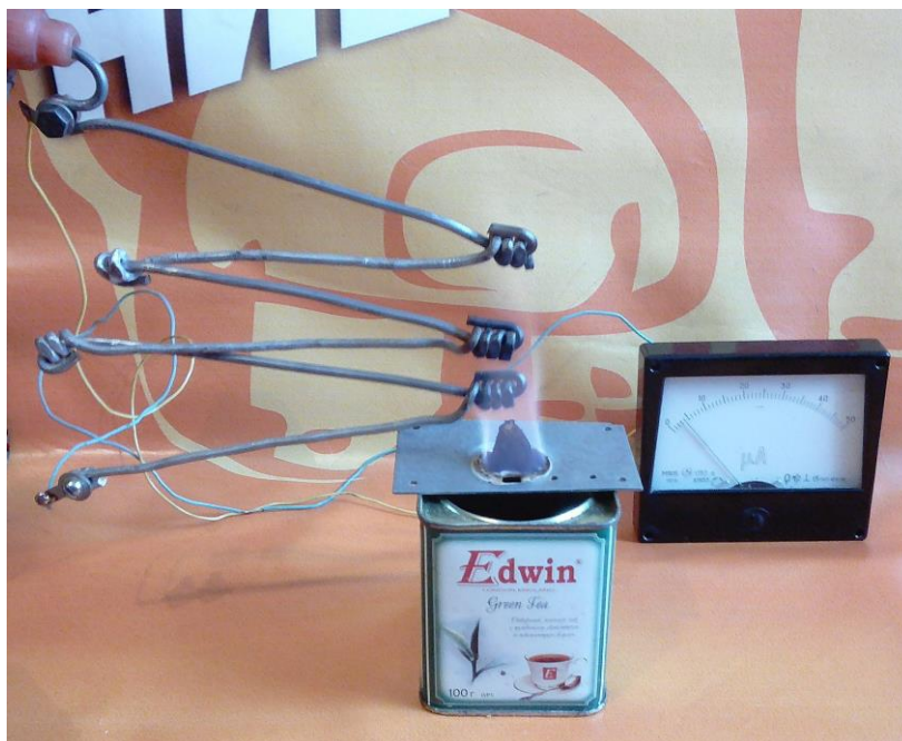
Фото 1. Батарея з трьох термопар залізо- алюміній «дає» 4 мкА
