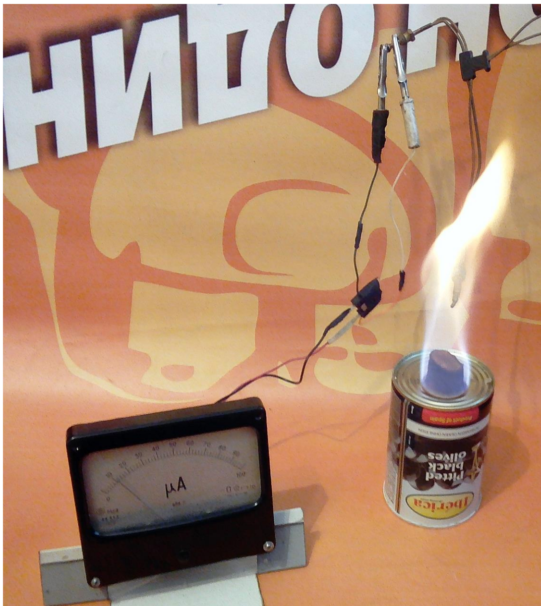
Фото 3. Перевірка роботи термопари для газової колонки
