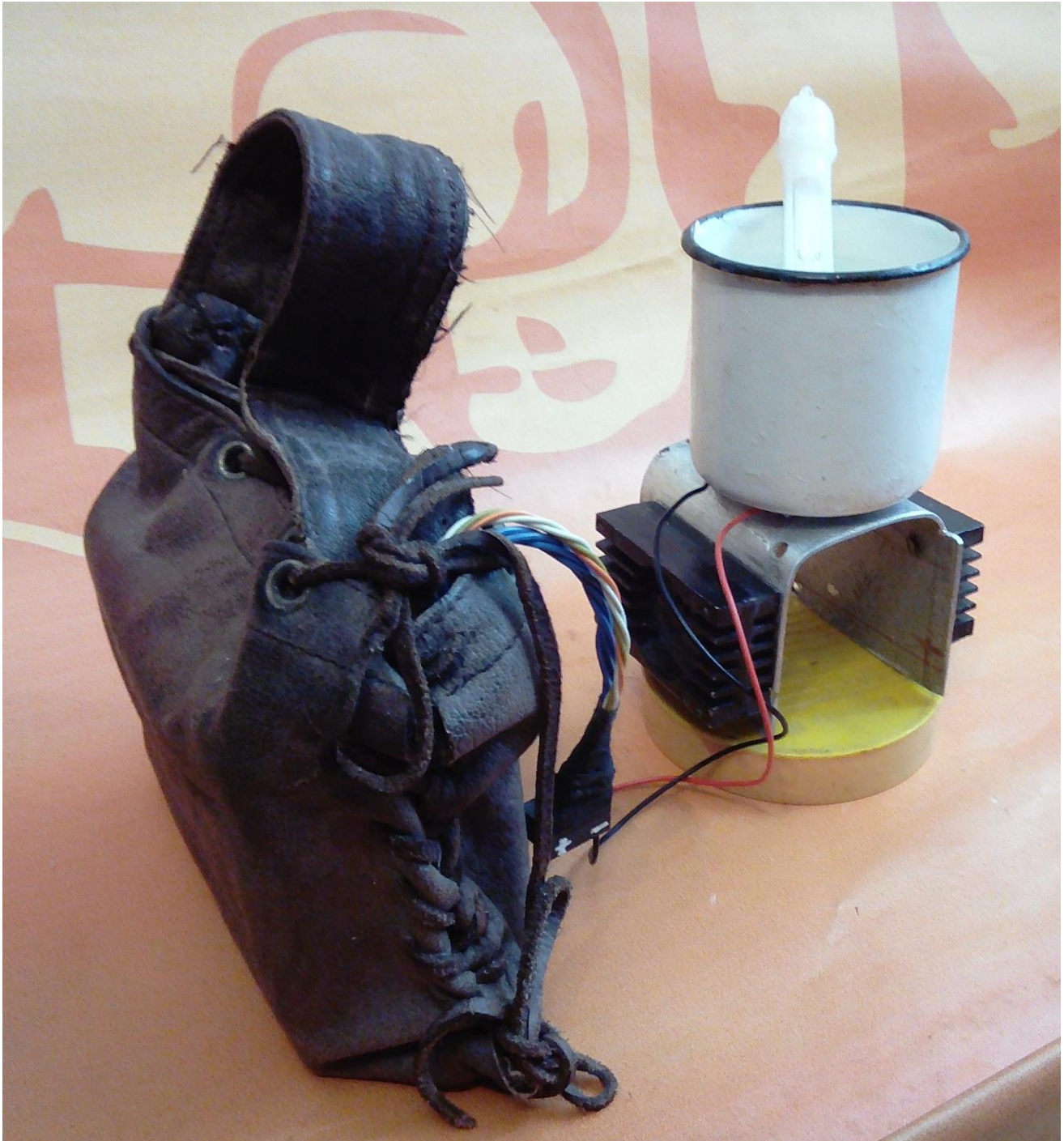
Фото 4. Пристрій для демонстрація термоелектричного охолоджувача
